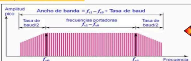
El ancho de banda necesario para una transmisión QAM es el mismo que para ASK y PSK.
