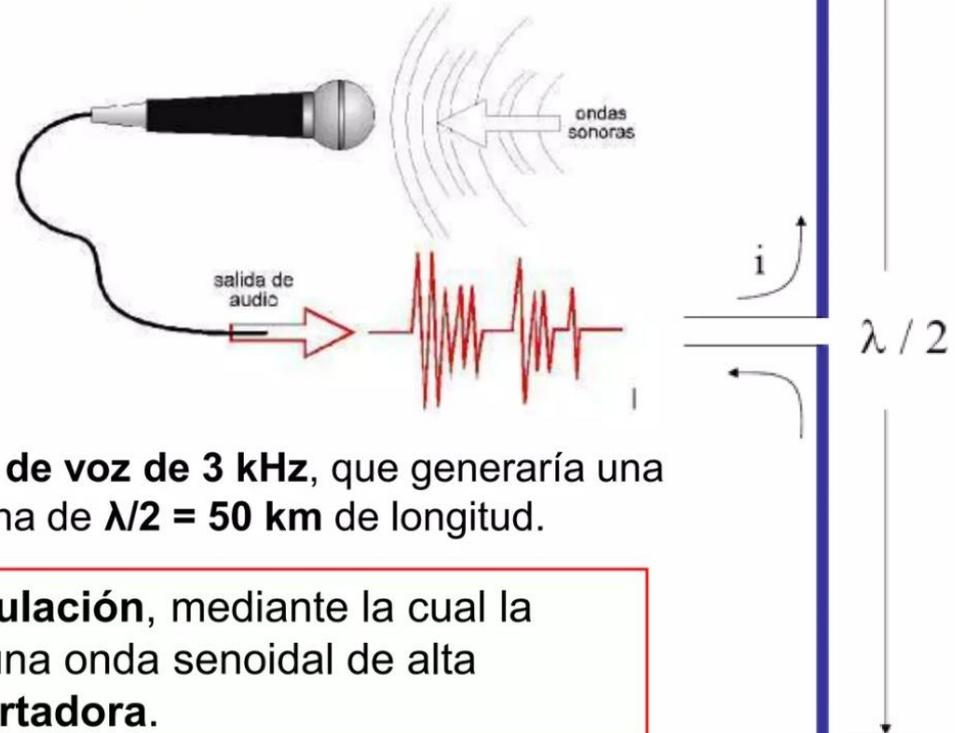
Por ejemplo, para transmitir un **tono de voz de 3 kHz**, que generaría una  $\lambda = 100 \text{ km}$ , se necesitaría una antena de  $\lambda/2 = 50 \text{ km}$  de longitud.
